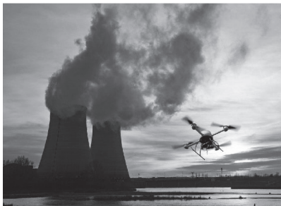
2.3.3-rasm. Geoeologik monitoringni olib borishda kvadrokopter va dronlardan foydalanish.
