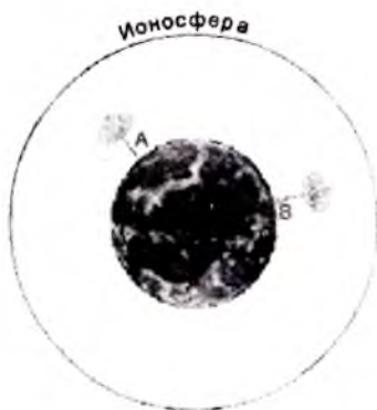
Рис. 115. Отражение волн СВ от ионосферы
