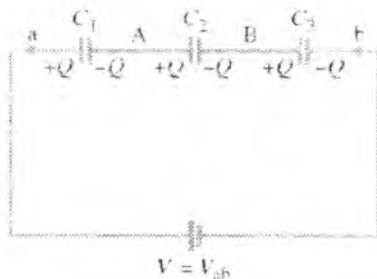
16-6-rasm. Kondensatorlarni ketma-ket ulash:
