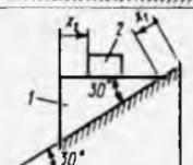
**20.3.12.** Uchburchak shaklidagi plastina momenti  $M=1\text{N}\cdot\text{m}$  bo'lgan just kuch ta'sirida vertikal o'q atrofida aylanadi. Uchburchakning gipotenuzasi bo'ylab sirpanuvchi moddiy nuqtaning massasi  $m=0,1\text{kg}$  bo'lib,  $\alpha=60^\circ$  ga teng. Moddiy nuqtaning siljishi  $x$  ni umumlashgan koordinata deb, unga mos keluvchi umumlashgan kuchning qiymatini hisoblang. (0,850)
