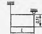
**17.3.43.** Radiusi  $r=0,25 \text{ m}$  bo'lgan silindr shaklidagi idish vertikal o'q atrofida  $\omega=10 \text{ rad/s}$  burchak tezlik bilan aylanadi. Idish ichida massasi 2kg bo'lgan to'rtburchak shaklidagi bir jinsli plastina gorizontal holatda A va B nuqtalarda idishga tiralib, idish bilan birga aylanadi. Shaklda ko'rsatilgan holat uchun A nuqtada hosil bo'layotgan reaksiya kuchini aniqlang. (16,3)
