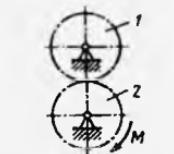
**15.7.5.** Radiusi  $R_2=2R_1$  bo'lgan ikki shkiv tasma yordamida bog'langan bo'lib, tinch holatdan o'zgarmas  $M=2,5\text{N}\cdot\text{m}$  juft kuch momenti ta'sirida harakatga keladi. Agar shkivlarning aylanish o'qiga nisbatan inersiya momentlari  $J_2=2J_1=1\text{kg}\cdot\text{m}^2$  bo'lsa, 1 shkiv uch marotaba aylangandan so'ng burchak tezligi nechaga teng bo'ladi? (11,2)
