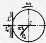
**22.4.6.** Massasi  $m=0,2\text{kg}$  bo'lgan shar aylanma harakatsiz  $v_0=2\text{m/s}$  tezlik bilan  $\alpha=45^\circ$  burchak ostida qo'zg'almas gorizontal tekislikka uriladi va  $\beta=60^\circ$  burchak ostida  $v=1,5\text{m/s}$  tezlik bilan yuqoriga sapchiydi. Urinma impuls  $\bar{S}_N$  ning modulini aniqlang. ( $2,30 \cdot 10^{-2}$ )
