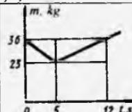
**23.1.9.** Reaktiv avtomobil nusxasi (modeli) ning massasi shakldagi grafik ko'rinishda o'zgaradi. Agar avtomobil reaktiv kuch ta'sirida harakatlanib, ajralib chiquvchi zarralarning nisbiy tezligi  $2,8 \text{ m/s}$  bo'lsa,  $t=10 \text{ s}$  paytdagi avtomobilning tezlanishini aniqlang. (0,112)
