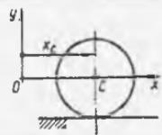
**17.2.18.** Massasi  $10\text{kg}$ , radiusi  $r_1=12\text{sm}$  bo'lgan bir jinsli disk radiusi  $r_2=20\text{sm}$  li silindrik sirtning tashqi tomoni bo'ylab dumalaydi. Agar disk markazi  $O$ ,  $s=50r^2$  ( $\text{sm}$ ) qonun bo'yicha harakat qilsa,  $t=1\text{s}$  paytdagi inersiya kuchlari bosh vektorining qiymatini toping. (32,8)
