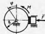
**20.2.5.** Radiusi  $R=0,25\text{m}$  bo'lgan silindr momenti  $M=25\text{ N}\cdot\text{m}$  juft kuch ta'sirida aylanib, massasi  $m=30\text{kg}$  li 1 jismni cho'zilmaydigan ip yordamida tortadi. Agar 1 jism va gorizontal tekislik orasidagi ishqalanish koeffitsiyenti  $f=0,2$  bo'lsa,  $x$  umumlashgan koordinataga tegishli bo'lgan umumlashgan kuchni aniqlang. (41,1)
