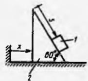
**20.6.19.** Massalari  $m_1=5\text{kg}$  va  $m_2=8\text{kg}$  bo'lgan jismlar  $\bar{F}_1$  va  $\bar{F}_2$  kuchlar ta'sirida harakat qilsa, umumlashgan koordinatalarni  $s_1$  va  $s_2$ , umumlashgan kuchlarini  $Q_{s1}=3\text{N}$   $Q_{s2}=5\text{N}$  deb, 2 jismning tezlanishi  $\ddot{s}_2$  ni aniqlang. (0,625)
