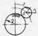
**17.2.19.** Massasi  $20\text{kg}$ , radiusi  $r_1=0,24\text{m}$  bo'lgan bir jinsli silindr radiusi  $r_2$  li doiraviy sirda dumalaydi. Agar silindr markazi  $O$  ning tezlanishi  $a=60\text{m/s}^2$  bo'lsa, silindr inersiya kuchlarining bosh momentini hisoblang. A nuqtani keltirish markazi deb olinsin. (-216)
