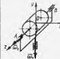
**16.3.15.** Massasi  $m = 100 \text{ kg}$  bo'lgan g'ildirak  $\omega_1 = 30 \text{ rad/s}$  va  $\omega_2 = 2,5 \text{ rad/s}$  burchak tezliklar bilan tekislik bo'ylab dumalab,  $O$  qo'zg'almas nuqta atrofida aylanadi. Agar g'ildirakning inersiya momenti  $J_{oz} = 1,12 \text{ kg} \cdot \text{m}^2$  va OC masofa  $1,1 \text{ m}$  bo'lsa, giroskopik moment ta'sirida hosil bo'lgan  $N$  tekislik normal reaksiyasini aniqlang. (76,4)
