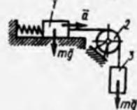
17.3.15. Massasi  $m_2=5\text{kg}$  bo'lgan 2 yuk og'irlik kuchi ta'sirida  $a=3\text{m/s}^2$  tezlanish bilan pastga tushib, massasi  $m_1=10\text{kg}$  li blokni aylantiradi. Agar aylanish o'qi blokning massa markazida bo'lsa, O sharnirda hosil bo'lgan reaksiya kuchining modulini aniqlang. (1,32)
