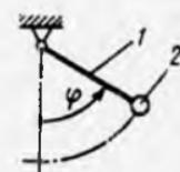
**20.4.10.** Massalari  $m_1=10\text{kg}$  va  $m_2=5\text{kg}$  bo'lgan ikki yuk vertikal tekislikda harakat qiladi. Agar 1 jismning tezligi  $v_1=3\text{m/s}$  bo'lganda ikkala jismalar gorizontal tekislikdan teng  $h=2\text{m}$  balandlikda bo'lganda, sistemaning kinetik potensialini aniqlang. Bu holatda sistemaning potensial energiyasini  $\Pi_0=0$  deb oling. (-227)
