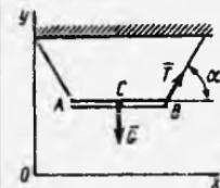
**16.2.14.** Massasi  $m=2\text{kg}$ , uzunligi  $AB=1\text{m}$  bo'lgan bir jinsli sterjen  $\varphi=45^\circ$  tinch holatdan harakatga kelib, uchlari bilan silliq devorga va silliq polga tiralib pastga sirpanadi. Agar  $A$  va  $B$  uchlardagi normal reaksiyalarini  $N_A=7,3\text{N}$  va  $N_B=12,2\text{N}$  bo'lsa, sterjenning  $\varepsilon$  burchak tezlanishini aniqlang. (10,4)
