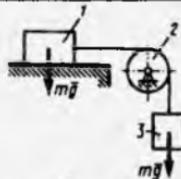
17.3.14. Massasi  $m=0,6\text{kg}$  dan bo'lgan 1 va 3 yuklar ip yordamida blok orqali bog'langan bo'lib  $a=3\text{m/s}^2$  tezlanish bilan harakat qilsa, 2 blokning massasini hisobga olmay, blok sharnirida hosil bo'lgan reaksiya kuchini toping. (5,78)
