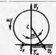
**22.4.4.** Gimnastik halqa burab otilgan bo'lib, yerga tushishdan avval uning massa markazi  $v_1=3\text{m/s}$  tezlikka ega bo'ldi. Zarbadan keyin halqa  $v_2=1,8\text{m/s}$  tezlik bilan yuqoriga sakraydi. Agar tushish va sakrash burchaklari  $\alpha=45^\circ$ ,  $\beta=32^\circ$  bo'lsa, normal impuls  $S_N$  ning tiklash koefitsiyentini toping. (0,720)
