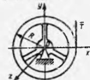
16.1.24. Massasi  $m=3\text{kg}$  bo'lgan g'ildirak burovchi moment  $M_z = 9t$  ta'sirida  $Oz$  o'qi atrofida  $\varphi = 2t^3$  qonun bilan aylansa, uning inersiya radiusini aniqlang. (0,5)
