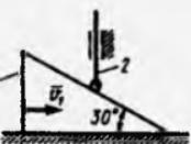
**15.5.10.** Massasi  $m_1=4 \text{ kg}$  bo'lgan 1 sterjen  $60^\circ$  burchak shaklida bo'lib, gorizontal yo'naltiruvchilar bo'ylab  $v_1=1 \text{ m/s}$  tezlik bilan harakat qiladi. Massasi  $m_2=2 \text{ kg}$  li 2 sterjen 1 sterjenga vtulka orqali bog'langan bo'lib, o'z yo'naltiruvchisi bo'ylab harakatlansa, sistemaning kinetik energiyasini aniqlang. (2,75)
