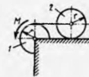
**20.5.16.** Radiuslari  $r_1=r_3=10\text{sm}$  va  $r_2=r_4=15\text{sm}$  bo'lgan g'ildiraklar momenlari  $M_1=5\text{N}\cdot\text{m}$  va  $M_2=9\text{N}\cdot\text{m}$  li juft kuchlari ta'sirida harakatga kelib,  $T=2 \dot{\phi}^2$  kinetik energiyaga ega bo'lsa, 1 g'ildirakning burchak tezlanishi  $\dot{\phi}$  ni aniqlang. (0,25)
