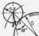
**17.2.20.** Krivoship  $\varpi = 4 \text{ rad/s}$  o'zgarmas burchak tezlik bilan aylanib, massasi  $m=4\text{kg}$  va radiusi  $r=15\text{sm}$  bo'lgan bir jinsli 2 g'ildirakni harakatga keltiradi. Agar g'ildirak radiusi  $R=40\text{sm}$  li silindrning ichki devori bo'ylab dumalasa, g'ildirak inersiya kuchlari bosh vektorining modulini aniqlang. (16)
