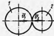
**22.2.10.** Massalari  $m_1=3\text{kg}$  va  $m_2=1\text{kg}$ , tezliklari  $v_{10}=5\text{m/s}$  va  $v_{20}=0$  bo'lgan jismalar to'g'ri markaziy zarbadan keyin bir xil  $v_1=v_2=3,75\text{m/s}$  tezlikka erishsa, kinetik energiyaning sarfini hisoblang. (9,38)
