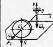
**16.3.16.** Inersiya momenti  $J_z = 1,5 \text{ kg} \cdot \text{m}^2$ , podshipniklar orasi  $a = 0,8 \text{ m}$  bo'lgan qayiqning motori o'z o'qi atrofida  $\omega_1 = 250 \text{ rad/s}$ , suv to'lqini natijasida  $\omega_2 = 0,1 \text{ sint}$  burchak tezliklar bilan aylansa, podshipniklarga tushadigan giroskopik reaksiyaning eng katta qiymatini aniqlang. (46,9)
