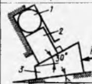
18.3.7. 3 ponaga  $F=100\text{N}$  kuch ta'sir etib, 2 richag yordamida 1 jismni qisadi. Agar  $\alpha=11^\circ$  bo'lsa, 2 richagning 1 jismga bosim kuchini aniqlang. (514)
