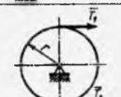
**16.1.12.** Massasi  $4\text{kg}$ , radiusi  $R=0,6\text{m}$  bo'lgan bir jinsli yupqa disk  $Az$  vertikal o'q atrofida  $M_z=1,8\text{N m}$  moment ta'sirida aylansa, diskning burchak tezlanishini aniqlang. (5)
