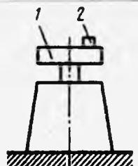
17.1.8. Vertikal o'qqa o'matilgan 1 gorizontal platforma amplitudasi  $1\text{mm}$  bo'lgan vertikal erkin tebranma harakat qiladi. Tebranish amplitudasini saqlagan holda tebranish chastotasini o'zgartirish mumkin. Agar platformaning ustiga qo'yilgan jism u bilan birga tebransa, chastotaning qancha eng katta qiymatida jism platformadan uzilmay, birga tebranadi? (15,8)
