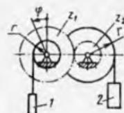
**20.2.12.** Radiuslari  $R_1=0,3\text{m}$ ,  $R_3=0,5\text{m}$  bo'lgan uchta g'ildirak friksion uzatmani hosil qilib, ularga momentlari  $M_1=15\text{N}\cdot\text{m}$  va  $M_3=5\text{N}\cdot\text{m}$  li juft kuchlar ta'sir etadi. Umumlashgan koordinata sifatida 1 g'ildirakning burilish burchagi  $\varphi_1$  ni olib, unga mos umumlashgan kuchni aniqlang. (12)
