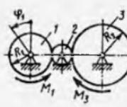
**20.2.13.** Radiuslari  $R_2=0,5\text{m}$ ,  $r_2=0,4\text{m}$  va  $R_3=0,2\text{m}$  bo'lgan shkvilr tasma yordamida bog'lanib, momenti  $M=25\text{ N}\cdot\text{m}$  bo'lgan juft kuch ta'sirida harakatga keladi. Agar 2 shkv massasi  $10\text{kg}$  bo'lgan 1 yukni yuqoriga tortsa, 3 g'ildirak aylanish burchagi  $\varphi_3$  ni umumlashgan koordinata sifatida tanlab olib, unga mos umumlashgan kuchni hisoblang. (9,30)
