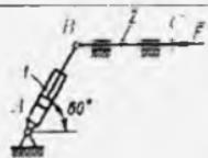
**18.3.19.** Mexanizmning 2 sterjeniga gorizontal  $F=3\text{kN}$  kuch ta'sir etadi. Muvozanatda turgan mexanizm gidrosilindirining porshenida hosil bo'ladigan bosim kuchini aniqlang. Bunda  $AB=BC$ . (6)
