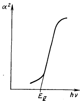
Рис. 11.4. Зависимость квадрата коэффициента поглощения при прямых разрешенных переходах от энергии
