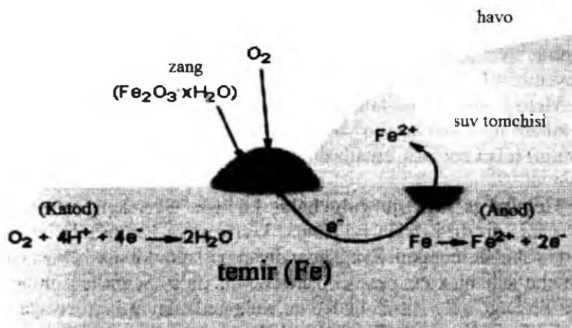
**18.1-rasm. Elektrokimyoviy korroziya mexanizmi**
