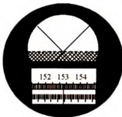
**7.4-rasm.** IRF-454 refraktometri okulyarining ko'rish maydoni
