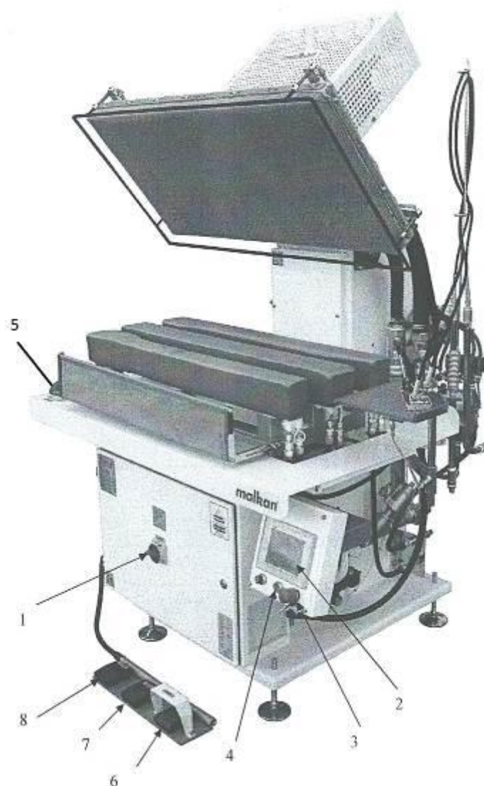
47-rasm. Kostyumning orqa va yon chokini tekislovchi press
