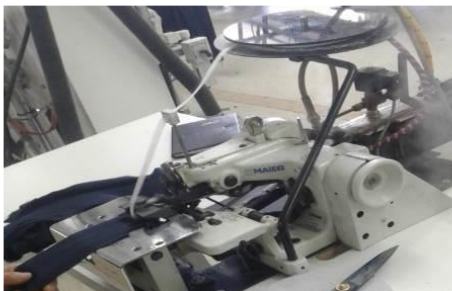
50-rasm. Kamartutgich tayyorlash jarayoni
