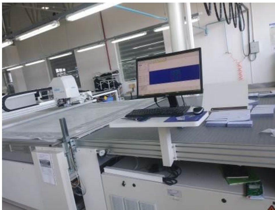
13-rasm. BULMER bichuv dastgohini ishga tushirishga mo'ljallangan avtomatlashtirilgan tizim
