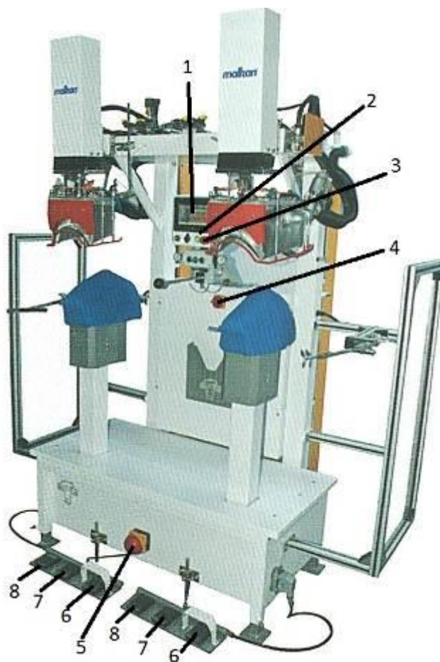
48-rasm. Kostyum yelka qismini press qiluvchi dastgoh
