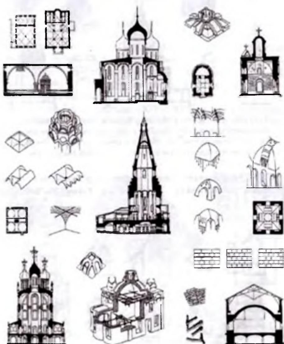
5.16 - rasm. XV-XVII asrlarda Moskva devlati arxitekturasida struktura tiplari va tash binolar konstruksiyalarini
