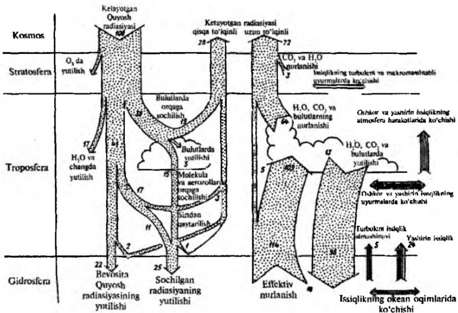
10-rasm. Yer iqlimi tizimining o'rtacha yillik issiqlik balansi sxemasi.
