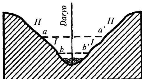
6.8-rasm. Daryo erozion terrasalarining ko'ndalang kesimi: daryo dastlab aa', keyin bb' punkti chiziqlari bo'yicha oqqan; I va II erozion terrasalar.
