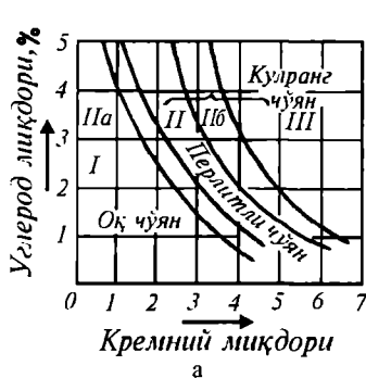
11-расм, а ва б. Углерод, кремний ва девор қалинлигининг чўян турига таъсир этиш графиги
