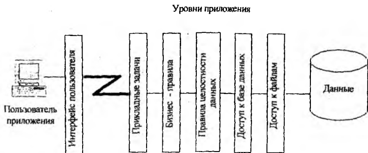
Рис. 5. Размещение большей части задач на сервере
