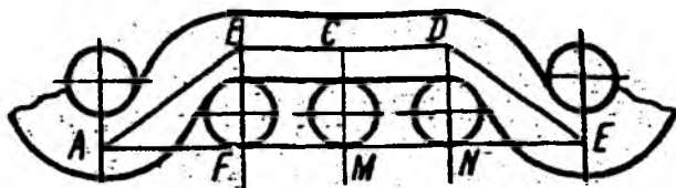
6.2-расм. Ипларнинг қисқаришини аниқлаш учун геометрик модел.
