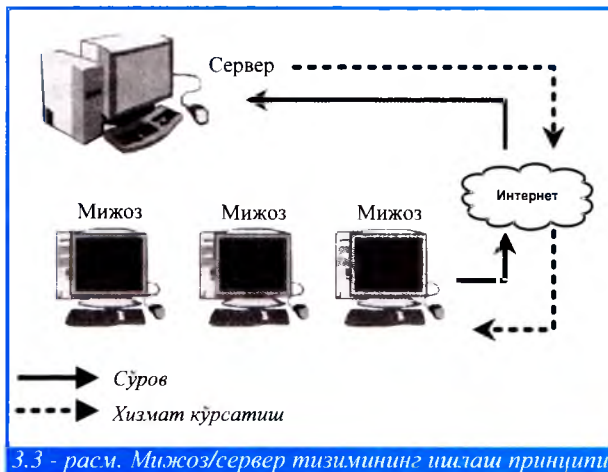
3.3 - расм. Мижоз/сервер тизимининг ишлаш принципи
