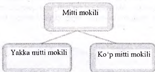
3.9-rasm. Mitti mokili arqoq tashlash turlari
