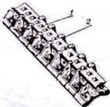
3.38-rasm. Rapira yo'naltiruvchisi 1-rapira, 2-yo'naltiruvchi.
