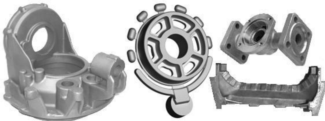
5.16.-rasm. Eruvchi modellar bo'yicha tayyorlangan quymalar.
