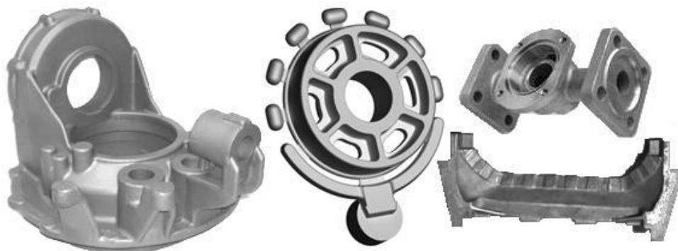
12-rasm. Eruvchi modellar bo'yicha tayyorlangan quymalar.
