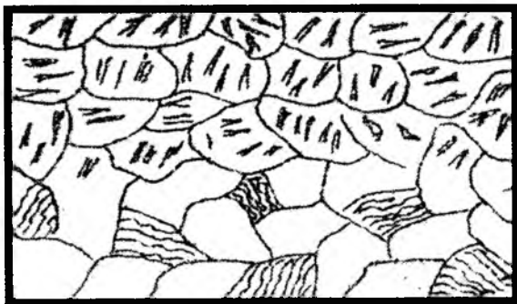
57-rasm. Sementitlangan va toblangan kam uglerodli po'lat mikrostrukturasi chizmasi
