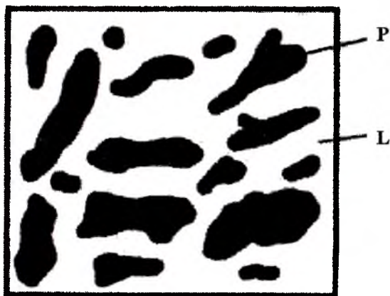
3.1-rasm. Evtektik oq cho‘yan strukturasi.
