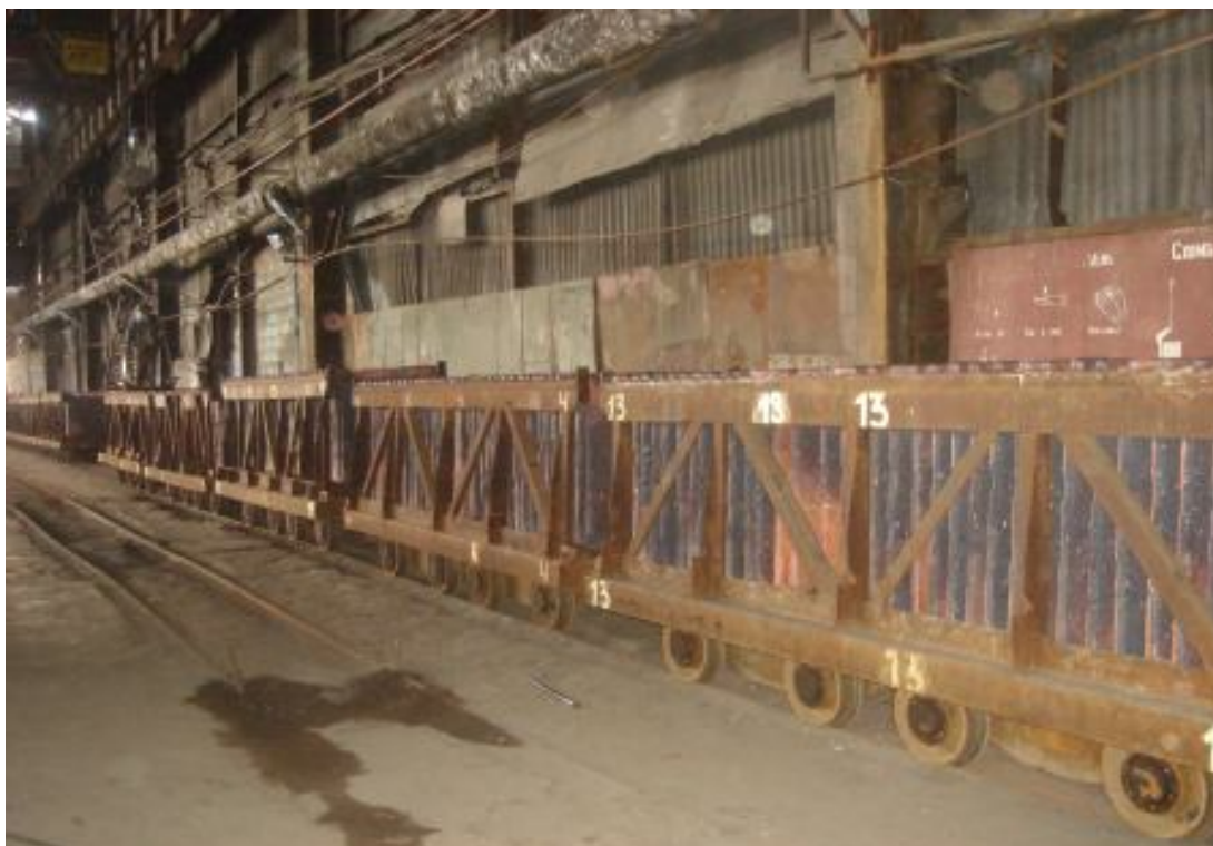
1.20-rasm. Qattiq holdagi anodlar vagonchalarga taxlanib, elektrolitik usul bilan qayta tozalash uchun elektroliz sexiga jo‘natilmoqda.
