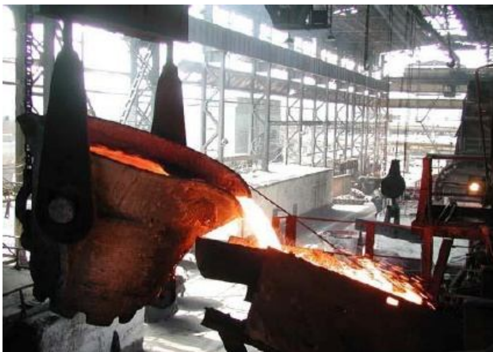
1.8-rasm. Suyuq holdagi konverter toshqolini ochiq nov orqali yallig‘ qaytaruvchi pechga quyish payti aks ettirilgan.
