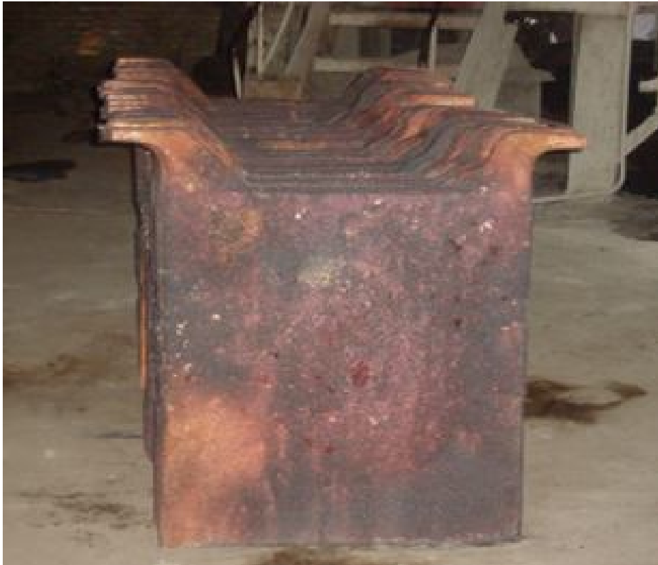
1.19-rasm. Anod pechidan olingan qattiq holdagi misli anod qotishmasining umumiy ko‘rinishi.
