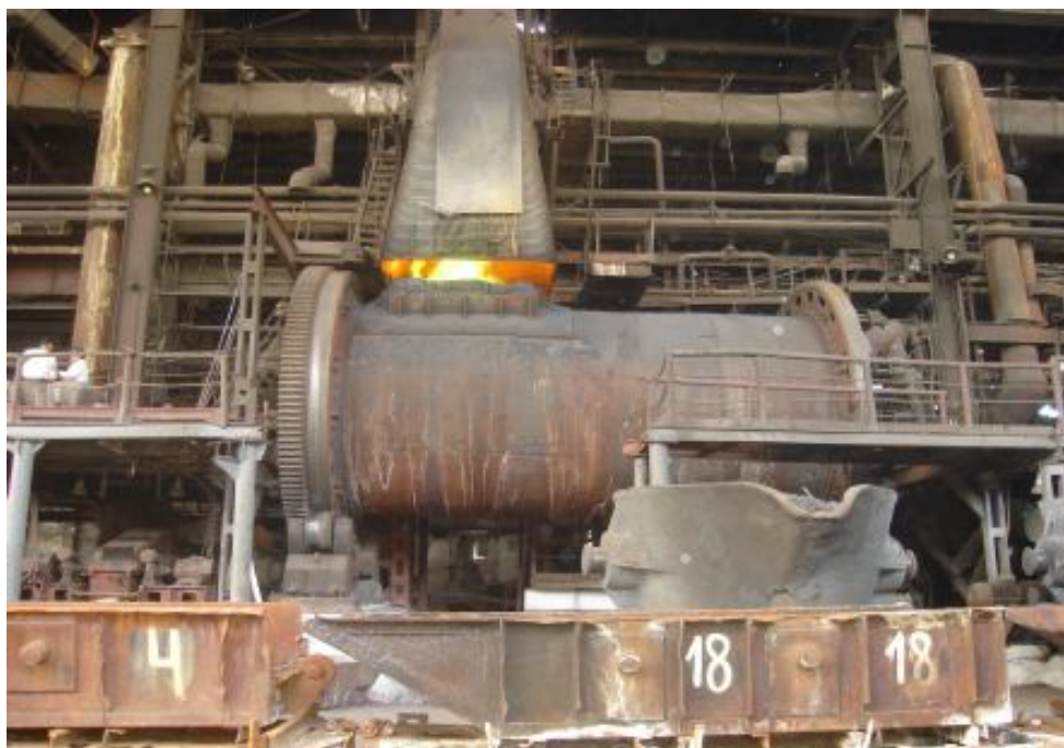
1.17-rasm. Qo'zg'aluvchan anod eritish pechining umumiy ko'rinishi. Unda pechning yon ko'rinishi, chiqayotgan oqova gaz mo'risi, o'ng tomonda esa tabiiy gaz beruvchi yondirgich ko'rsatilgan.
