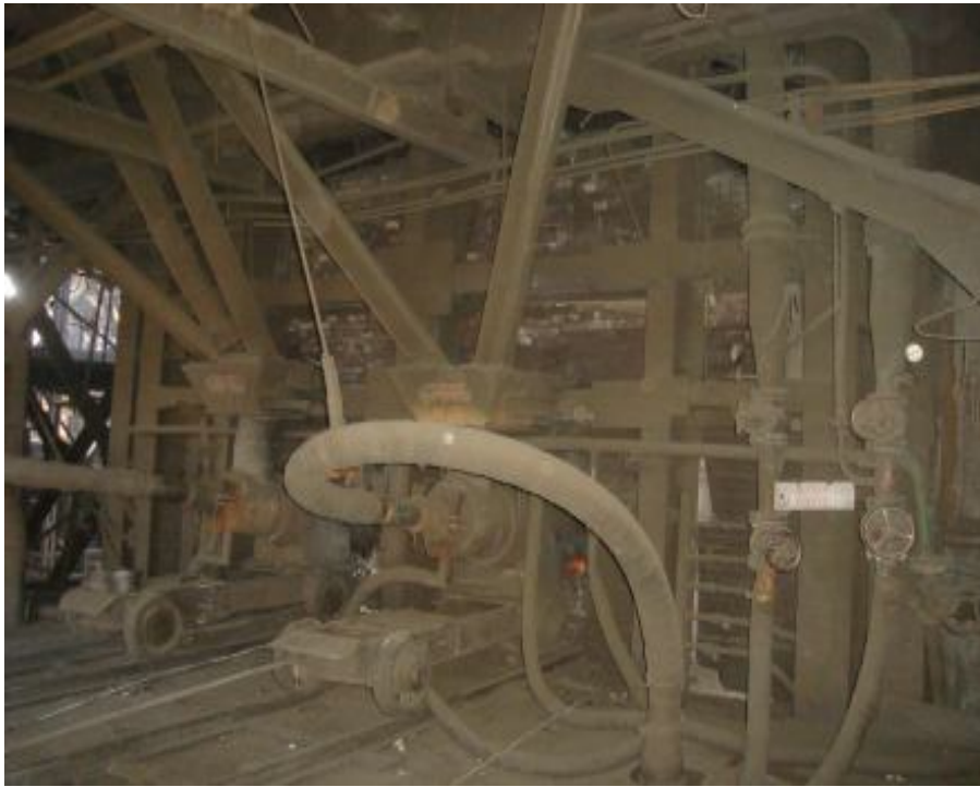
1.11-rasm. KME pechining umumiy old ko‘rinishi. Unda 2 ta kislorodli purkagich, yondirgich xomashyo kelib tushadigan har ikkala quvur ko‘rsatilgan. Yondirgich qurilmasi to‘liq qo‘zg‘aluvchan bo‘lib, u temiryo‘l ustiga o‘rnatilgan.
