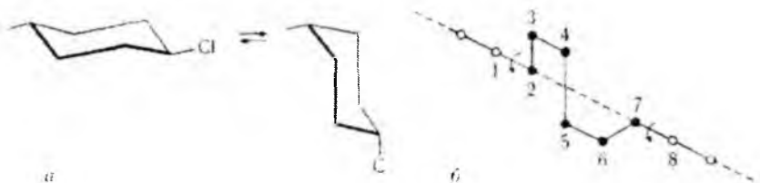
5.26- rasm. Relaksatsiyani molekulyar mexanizmlari: (a) Klortsiklogeksanda konformatsion to'ldirilish, (b) Polietilinda tirsakli val turidagi aylanish.
