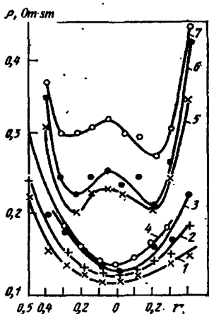
II.54-rasm. Alumiiniy kirishmasi kiritilgan kremniy monokristallarining ko'ndalang kesimi bo'yicha solishtirma elektr qarshilik taqsimoti:
