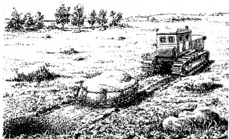
3.1.12-rasm. Katta toshlarni zanjir bilan bog'lab tashish tartibi.
