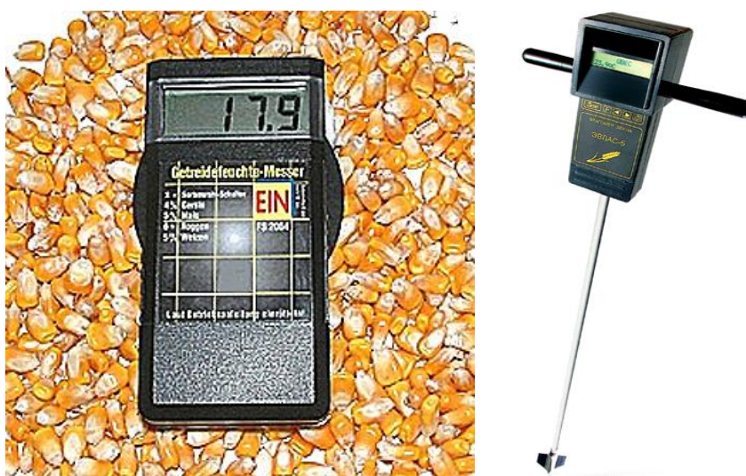
1-rasm. Don namligini aniqlaydigan zamonaviy elektron asboblarda
