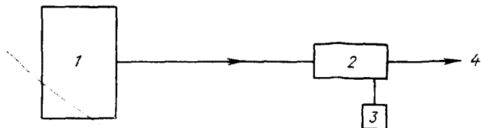
20- расм. Чиқинди сувни тиндириш ва хлорлаш.
