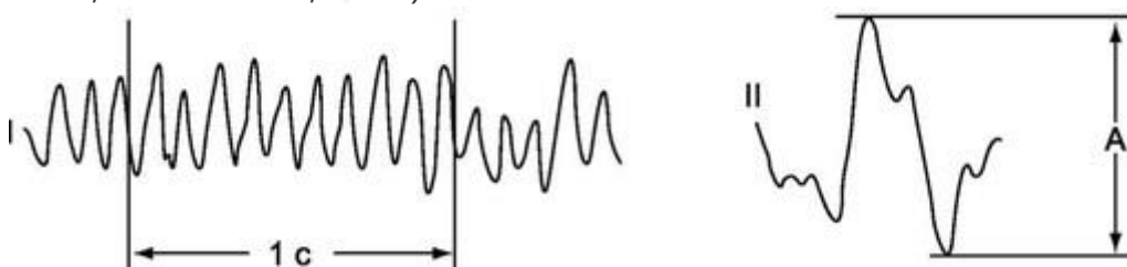
Рис. 2.82. Измерение частоты (I) и амплитуды (II) на электроэнцефалограмме. Частота измеряется как количество волн в единицу времени (1 с). А - амплитуда
