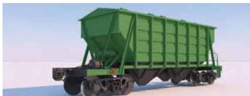
Вагон-хоппер обеспечивает перевозку по железным дорогам зерна и других аналогичных пищевых продуктов насыпью с гравитационной погрузкой через верхние люки. Привод механизма разгрузки ручной. Данный вагон используется также и для перевозки минеральных удобрений, при этом в качестве лакокрасочного покрытия кузова вагона применяется эмаль на основе эпоксидных смол.
