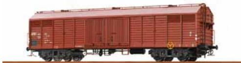
Крытый вагон предназначен для транспортировки по железным дорогам тарно-штучных, штабельных, пакетированных и некоторых сыпучих (зерно) грузов, требующих защиты от атмосферных осадков. Используется как универсальное транспортное средство, для перевозки грузов не требующих особых условий транспортировки.
