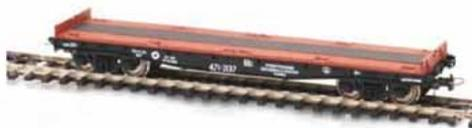
Предназначена для перевозки длинных и громоздких грузов, преимущественно, лесоматериалов, строительных материалов, контейнеров, машин на колесном ходу в пределах внутреннего габарита данного вагона, не требующих укрытия от атмосферных осадков. С выгрузкой на пунктах, имеющих приемо-разгрузочные устройства, при условии, что способы размещения и крепления грузов в вагоне возможны в соответствии с действующими 'Техническими условиями погрузки и крепления грузов.
