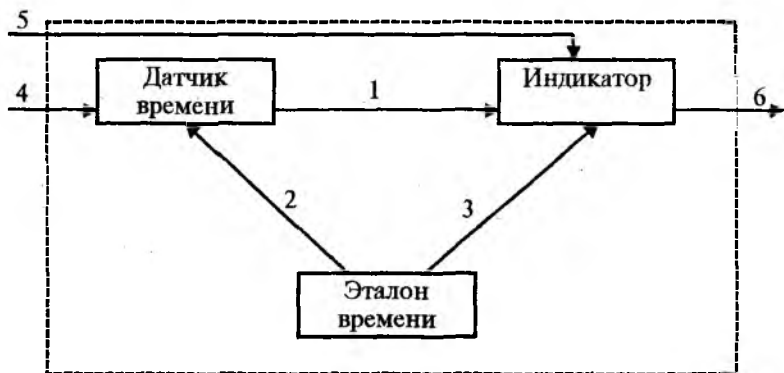
Рис. 2. 11. Структурная схема системы “синхронизирующие часы”: 1, 2 и 3 – отношения (связи) внутри системы ; 4 и 5 – входы ; 6 – выход
