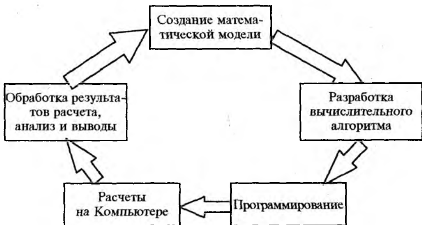
Рис 4.03. Схема технологического цикла вычислительного эксперимента
