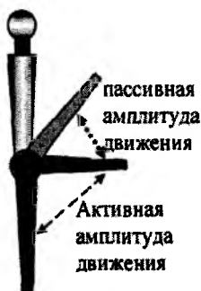
Рис. 17. Амплитуда активных движений (за счет активного сокращения мышц, создающих рабочий момент относительно сустава) и пассивных (при помощи внешней силы)
