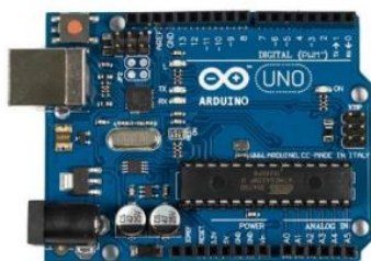
1-rasm. Arduino Uno - Atmega 328 mikrokontroller platasi.
