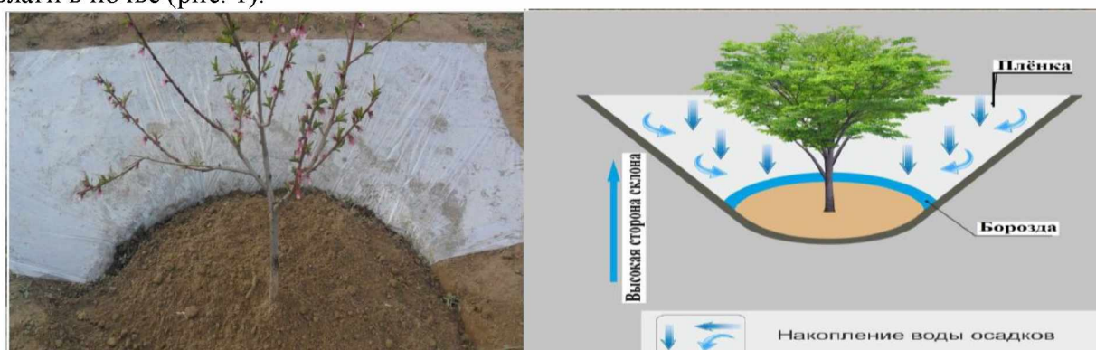
Рис. 1. Схема увеличения площади накопления осадков покрытием плёнкой
