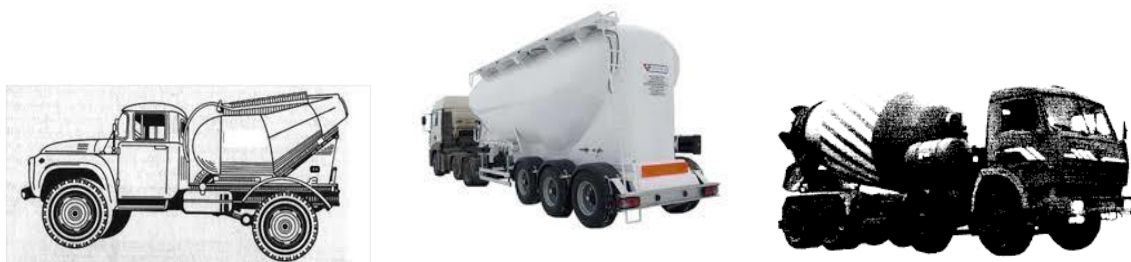
2-расм. Узоқ масофага ташишда бетон ва бетонқоришма ташувчи махсус автомобиллар.
