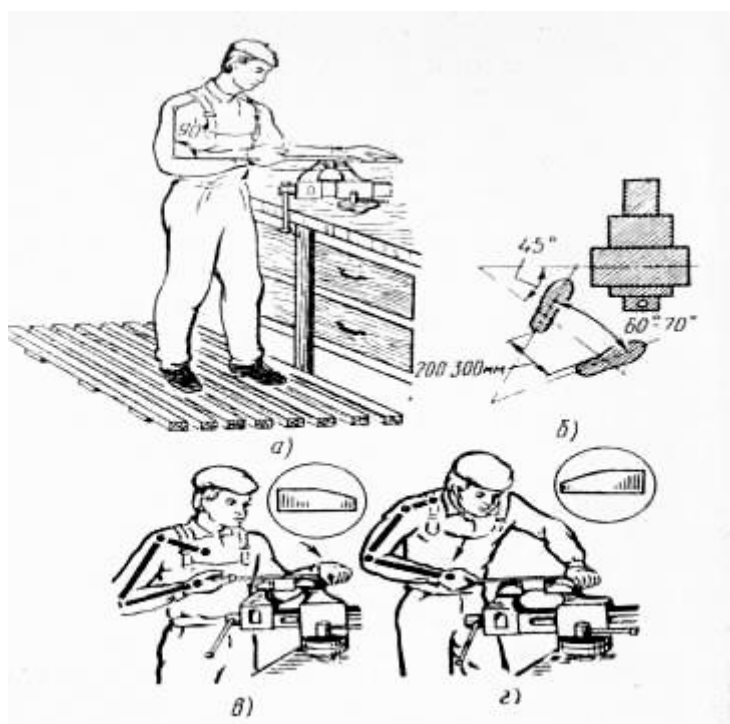
3-rasm. Egovlashda ish vaziyati: a-gavdaning vaziyati, b-oyoqlarning vaziyati, v-egovga ozgina bosish, g-egovga quchli bosish
