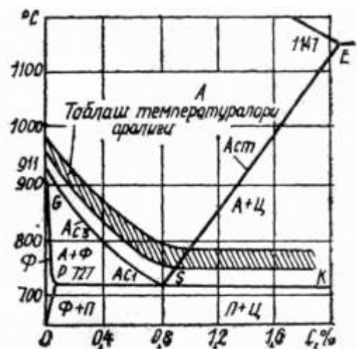
3-rasm. Po'latni toblashda qizdirish temperaturasi oraliqlari.
