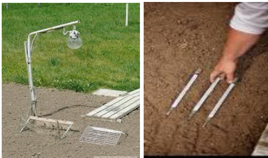
16-rasm. Tuproq sirti termometrlarining o'rnatilishi.
