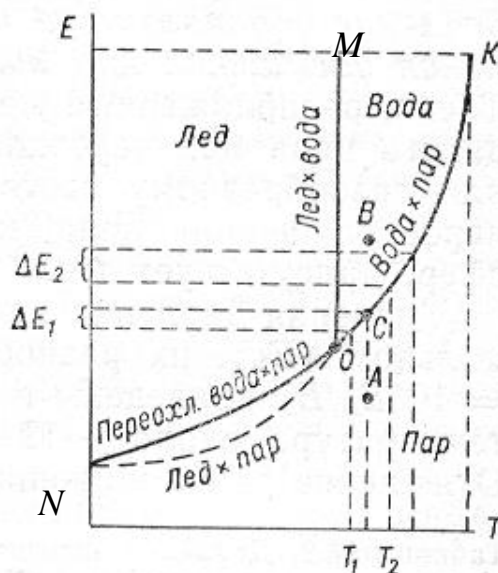
46-rasm. To'yinish bosimining bug'lantiruvchi sirtning harorati va fazaviy holatiga bog'liqligi.
