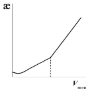
**Рис. 5.** Кривая кондуктометрического титрования слабой кислоты сильным основанием.
