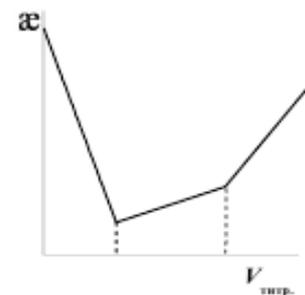
**Рис. 6.** Кривая кондуктометрического титрования смеси сильной и слабой кислот сильным основанием.
