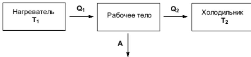
Рис. 1.1 Схема тепловой машины
