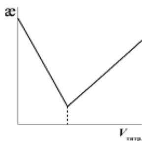
**Рис. 4.** Кривая кондуктометрического титрования сильной кислоты сильным основанием.
