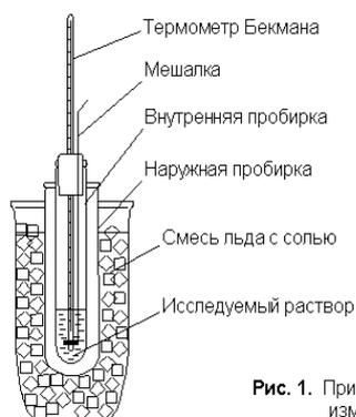
Рис. 1. Прибор для криометрических измерений.
